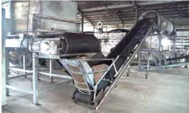
投入機、ベルトコンベア、トロンメル
