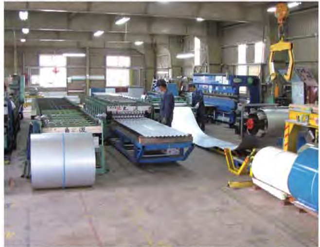
丸波、角波、ルーフデッキ、棟押さえ、水切り加工
