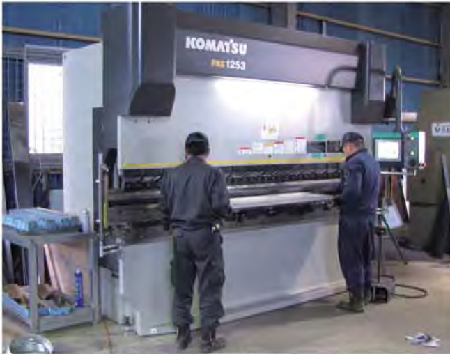
プレスブレーキPBZ1253E (コマツ製)
