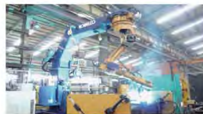
工場加工機械設備 鉄骨天吊りロボット
