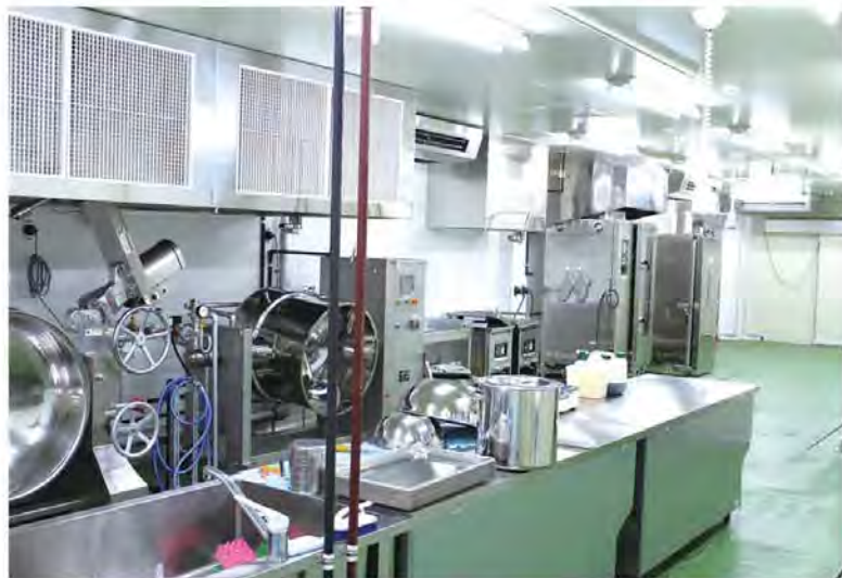
蒸気釜やスチームコンベクションにより、煮る、炒める、焼くなどの加工ができます。
