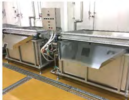
エア-反転式蒸気加熱装置
