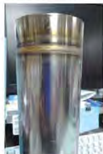
配管自動溶接機で作成 (サンプル)
