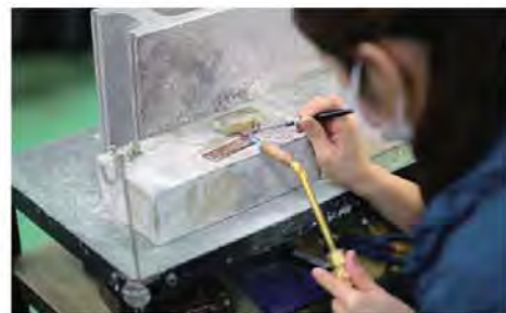
ロウ付け作業
