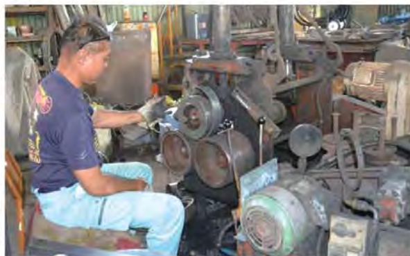
鋼管を繋ぐための部品の製作を行っている様子です。 機械は弊社のオリジナル製品です。
