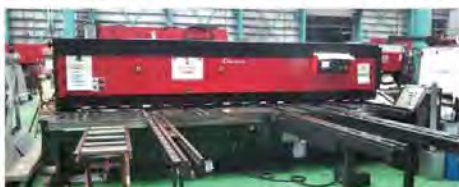
2019年8月アマダ製メカニカルシャーリングマシンM4065リターンショートコンベア付
