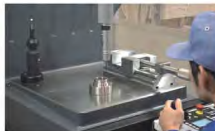
三次元測定器を用いた高精度測定
