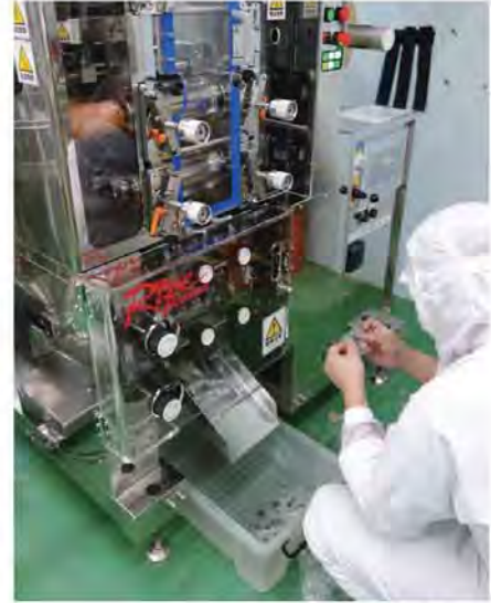
小袋充填機での充填作業
