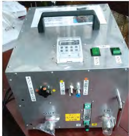
オゾンナバブル水・農水産物殺菌処理装置
