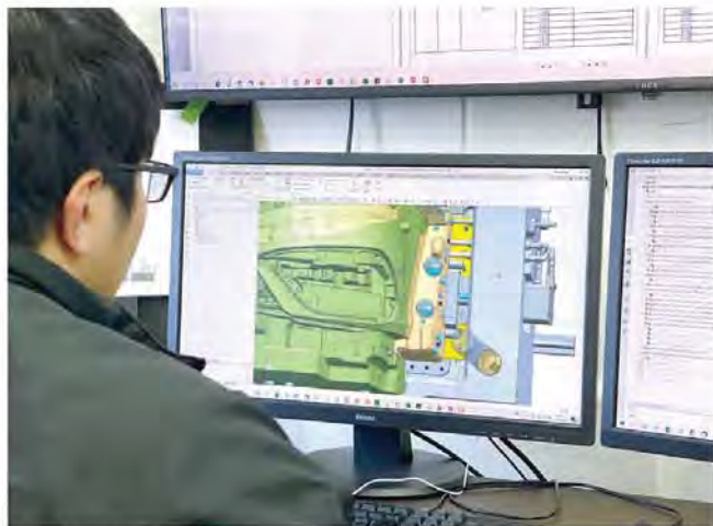
3次元CADによる金型設計
