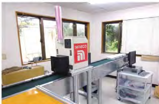
非破壊糖度センサー付き選果機
