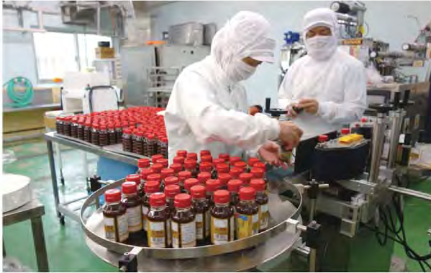
ラベラーによるペットボトルへのラベル貼り作業
