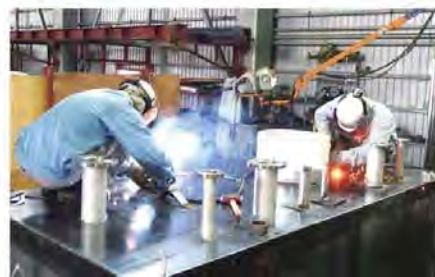
コンボルト型タンクの製造
