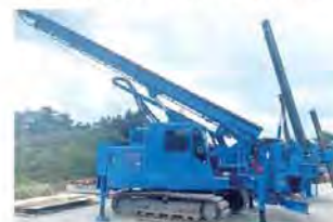
鋼管杭 施工機械 (DHJ-25型)
