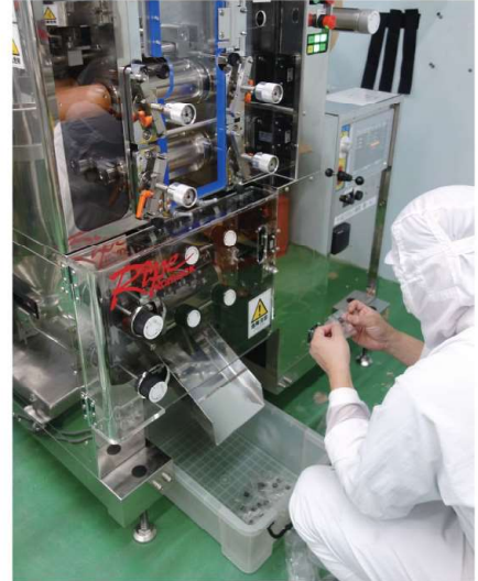
小袋充填機での充填作業
