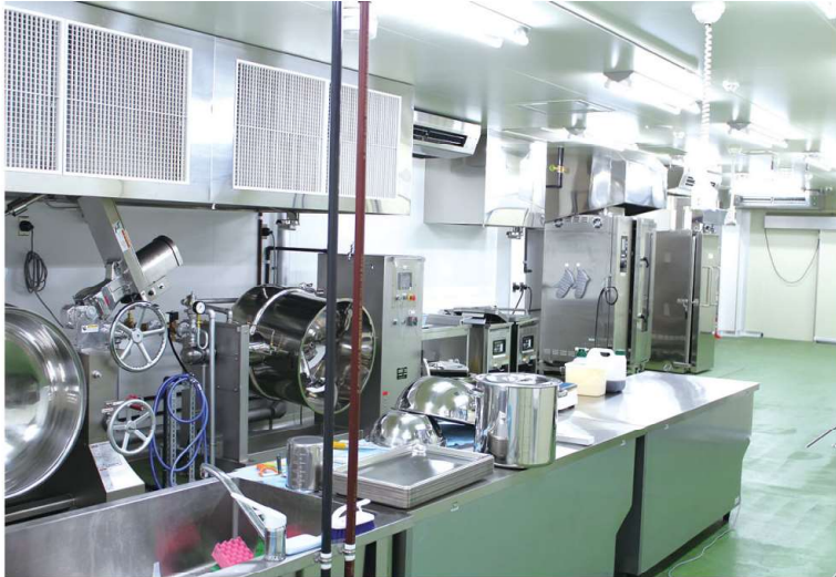
蒸気釜やスチームコンベクションにより、煮る、炒める、焼くなどの加工ができます。
