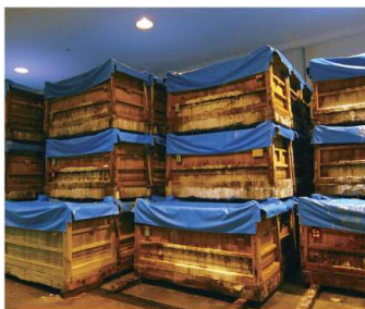
木箱による自然脱水工程
