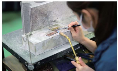
ロウ付け作業
