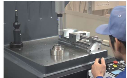
三次元測定器を用いた高精度測定
