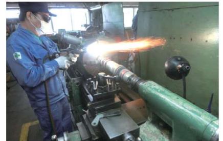
メタライズ加工（溶射加工）
