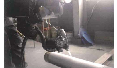
自社工場での柱への溶射 (亜鉛・アルミ合金)
