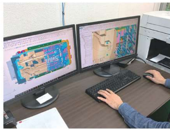
3次元CADによる金型設計
