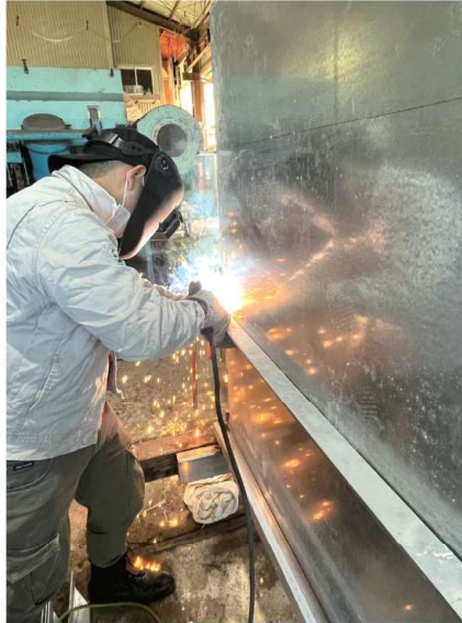
工場内作業 アーク溶接
