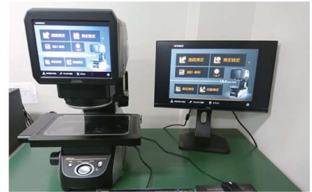
画像寸法測定器による製品検査
