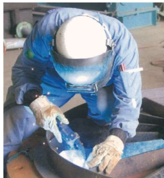
製品の溶接作業→完了後 旋盤加工
