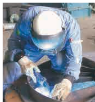
製品の溶接作業→完了後 旋盤加工
