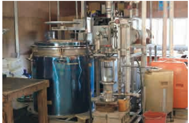
【水蒸気蒸留装置】
