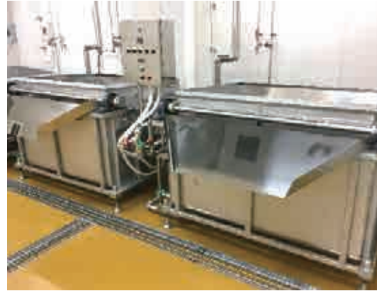
エア-反転式蒸気加熱装置
