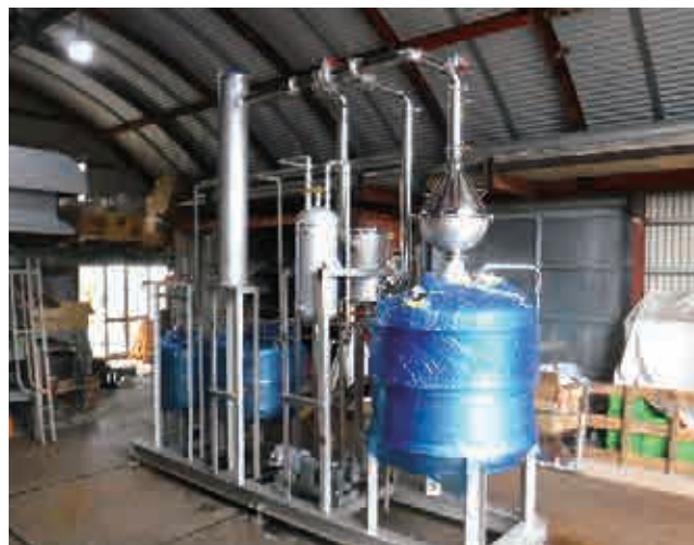
300L泡盛製造蒸留機
