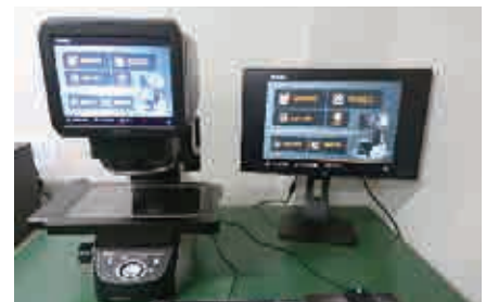
画像寸法測定器による製品検査
