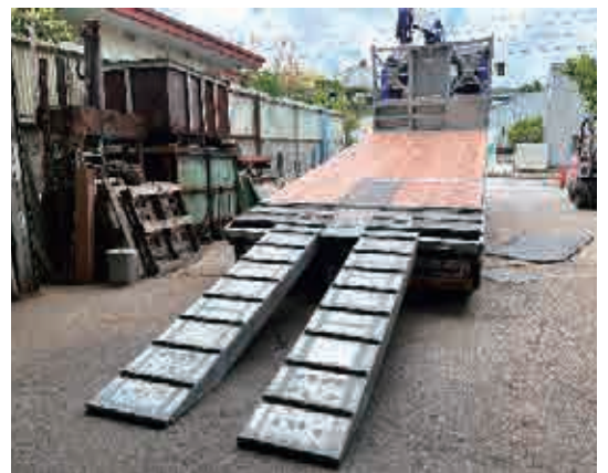
【車両架装】荷台から油圧ジャッキまで工場一環で製作した車両です(重機回送車)
