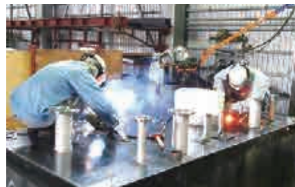
コンボルト型タンクの製造
