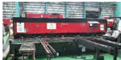
2019年8月(株)アマダ社製メカニカルシャーリングマシンM4065リターンショートコンベアー付
