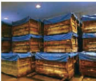
木箱による自然脱水工程
