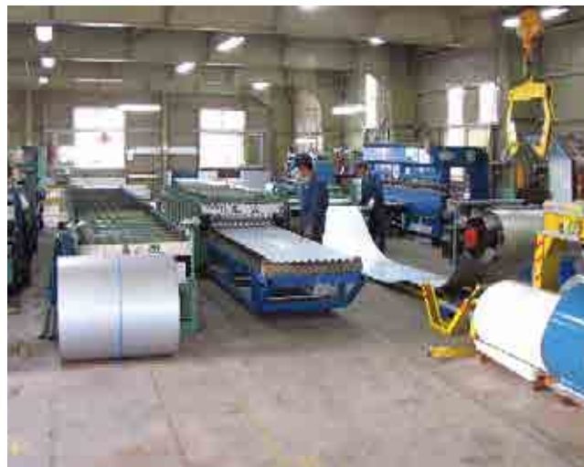
丸波、角波、ルーフデッキ、棟押さえ、水切り加工
