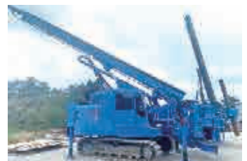
鋼管杭 施工機械 (DHJ-25型)
