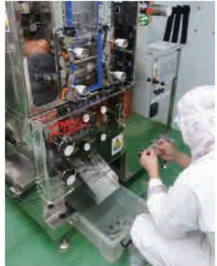
小袋充填機での充填作業
