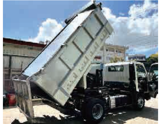
通常ダンプをステンレスにて嵩上げ、密閉用に製作した車両
