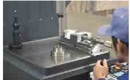
三次元測定器を用いた高精度測定
