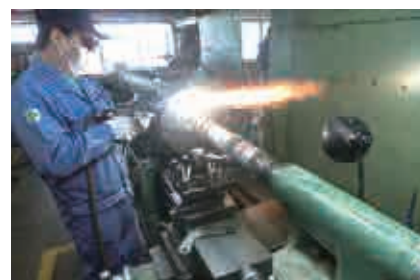
メタライズ加工（溶射加工）
