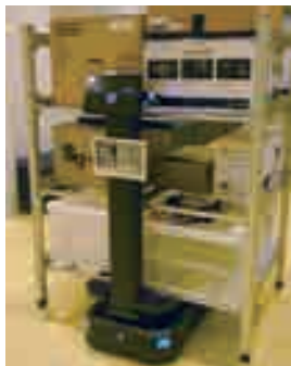
工業用搬送ロボットT300 (積載量300kg)
