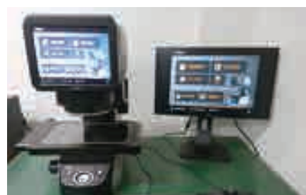
画像寸法測定器による製品検査
