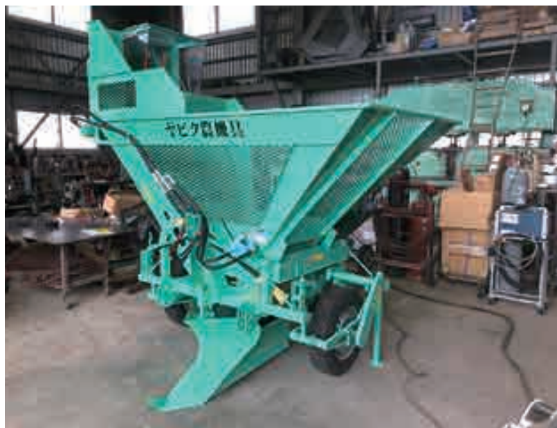
全自動植え付け機 (小型) 型式YS-30-3P (前面)
