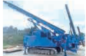
鋼管杭 施工機械 (DHJ-25型)
