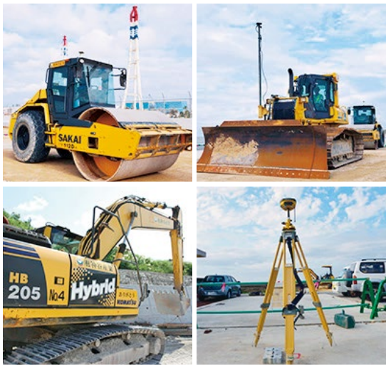
神谷産業が所有する主なICT建機（右上から反時計回りに：ブルドーザー、振動ローラー、ハイブリッドバックホウ、衛星通信基地局）。工事の生産性向上はもちろん、ハイブリッド機の導入で25～30%の燃費削減を実現。コスト削減と環境保全にも役立っている
