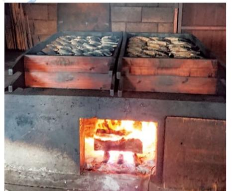
「日本一小さい加工場」と自称する工場。カマドで薪を燃やし、その上に釜茹でしたカツオを載せたセイロを置いて、燻製しながら乾燥させる伝統的な手火山式直火焙乾は手間暇がかかるため、一日の生産量は50～60本が限界とのこと
