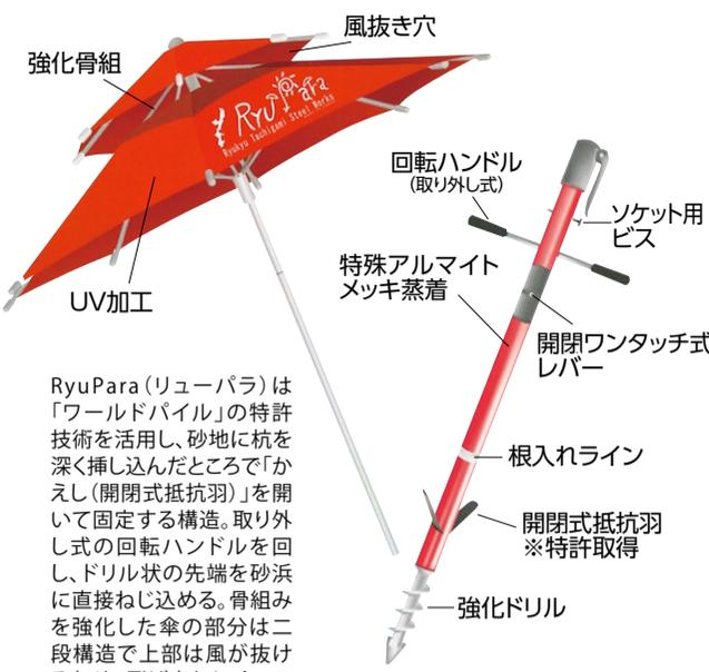
RyuPara(リューパー)は「ワールドパイル」の特許技術を活用し、砂地に杭を深く挿し込んだところで「かえし(開閉式抵抗羽)」を開いて固定する構造。取り外し式の回転ハンドルを回し、ドリル状の先端を砂浜に直接ねじ込める。骨組を強化した傘の部分は二段構造で上部は風が抜けるため、飛ばされにくいのも特徴だ
