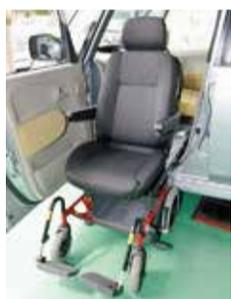
助手席のシートがそのまま車椅子になるスウェーデン製の介護装置などの取り扱いもしている
