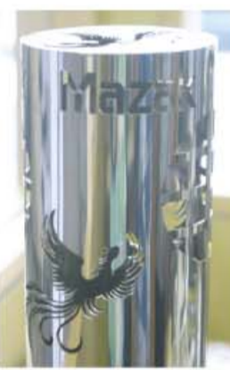
円柱状の金属にも、精密な細工を施すことができる
