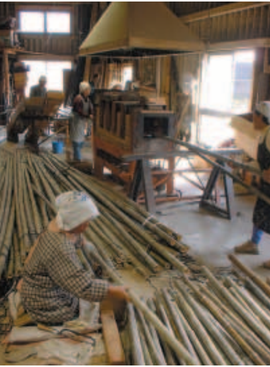
竹の虎模様をより鮮明にするための「虎斑竹」炙り作業
