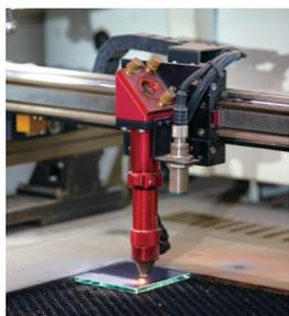
レーザーを使って高速でガラスを彫り、多彩な模様を作る
