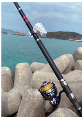
釣り竿に取り付けて使用。竿の振動と傾斜に反応する
