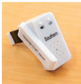
魚のアタリを知らせるサザンセンサー。サイドにあるバーでアタリに反応する感度を調節できる
