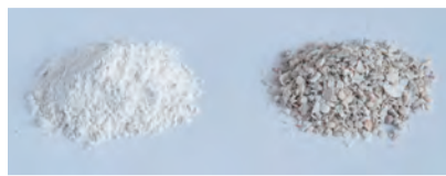
原料となる風化造礁サンゴ。細かく砕いて使用している
