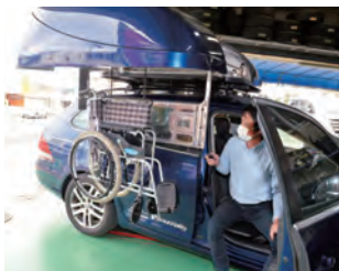
自操式に改造したBMW。運転席への移動、車いすの格納まで一人で操作できる
