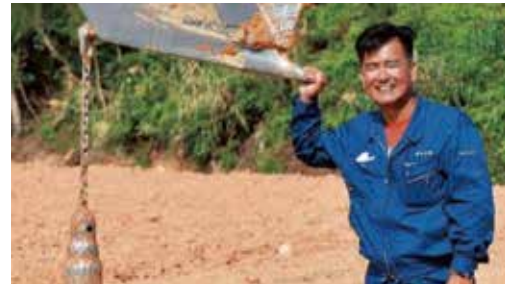
1 リッパーは掘削と同時に地中に円形の水路を形成可能
